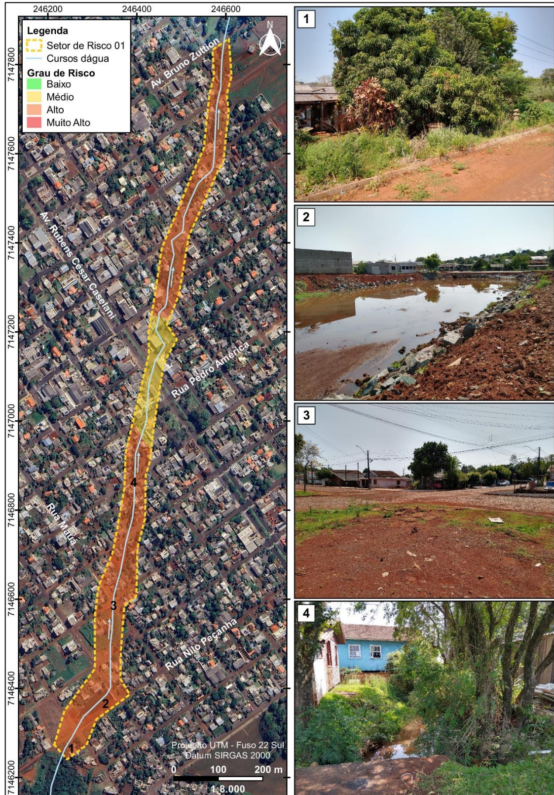
Figura 77 - Classificação de Risco do Setor 01 e fotografias da área: 1 e 3) Locais com registros de ocorrência de inundação; 2) Vista geral da Bacia de Retenção; 4) Local sem contenção de margem, aumentando o risco de solapamento, devido à proximidade das moradias ao leito.
