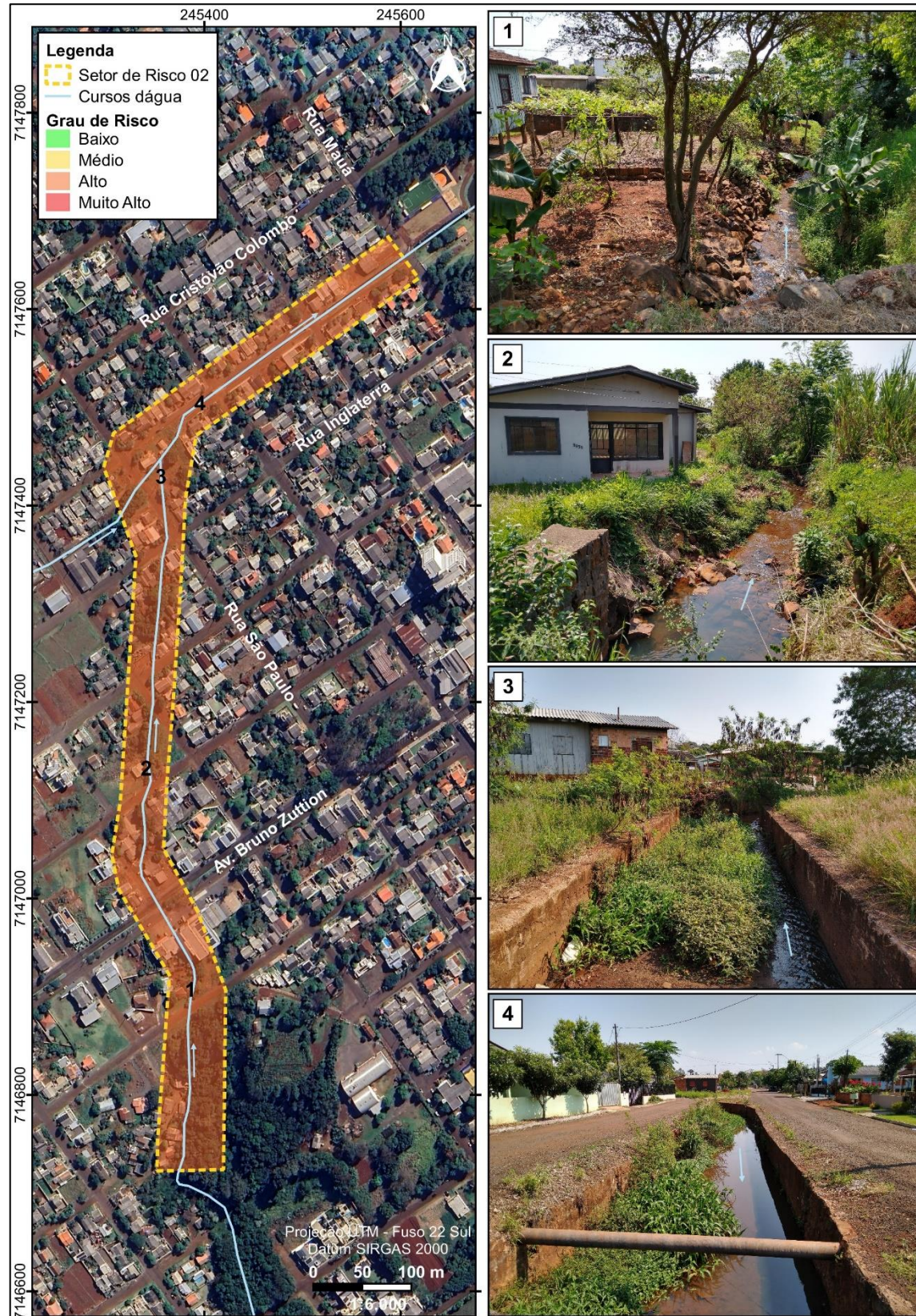
Figura 79 - Classificação de Risco do Setor 02 e fotografias da área: 1 e 2) Trechos sem contenção de margem, onde pode ocorrer o solapamento de margem; 3 e 4) Locais com registros de inundação, onde se observa o assoreamento do leito do curso.
